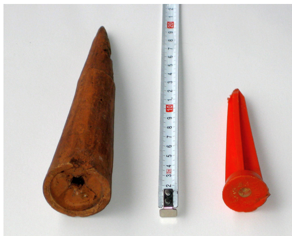
Unterirdische Vermarkungen, hier: Tonkegel und Plastikkegel
